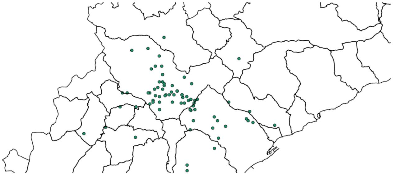
**Sismicità strumentale rilocalizzata e selezionata in funzione della qualità delle localizzazioni (errori di localizzazione minori di 5km)**
