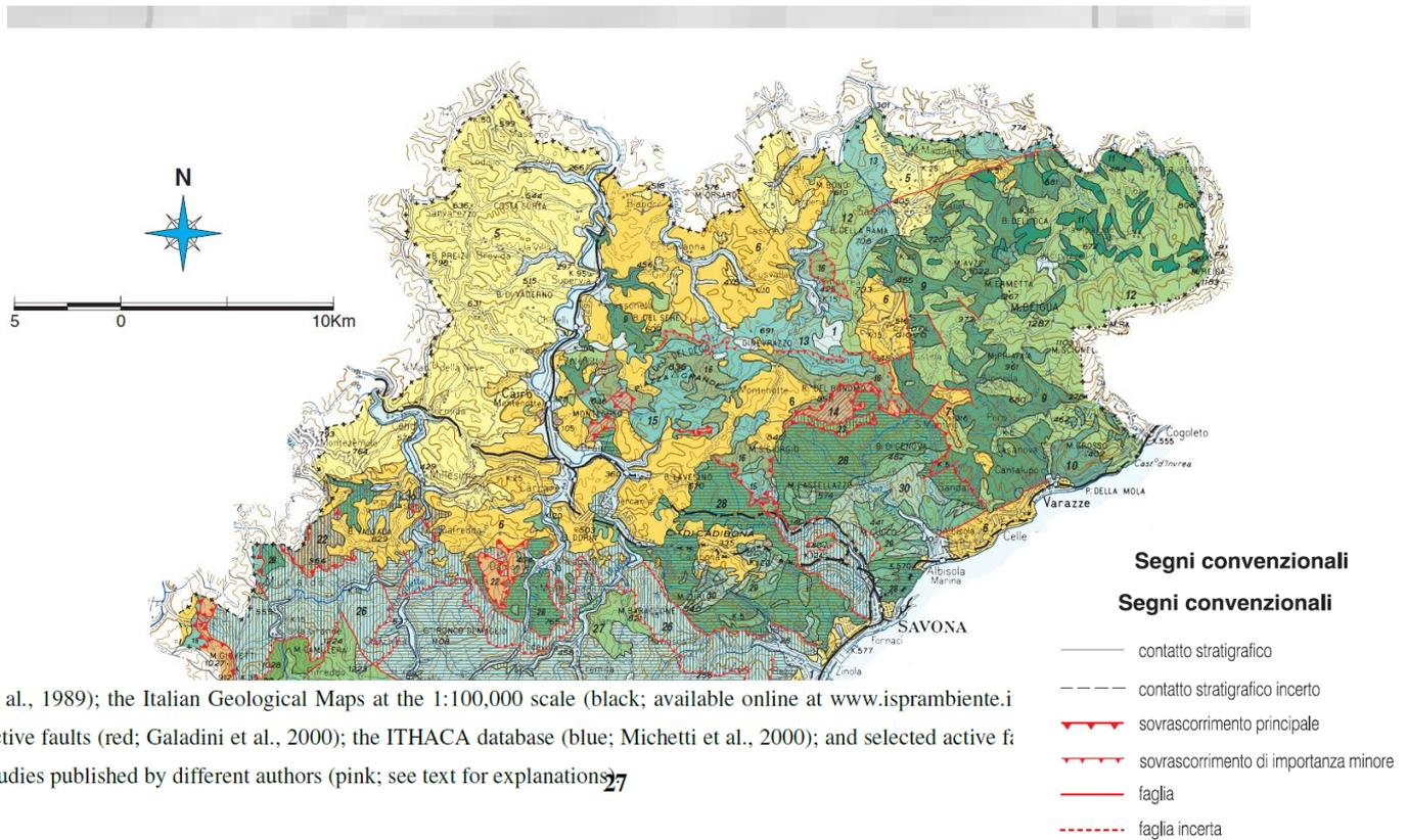
**Figura 1 – Schema geologico strutturale della Provincia di Savona; ripreso dalla Carta Geologica della Liguria, scala 1:200.000 (Giammarino et al, 2002).**
