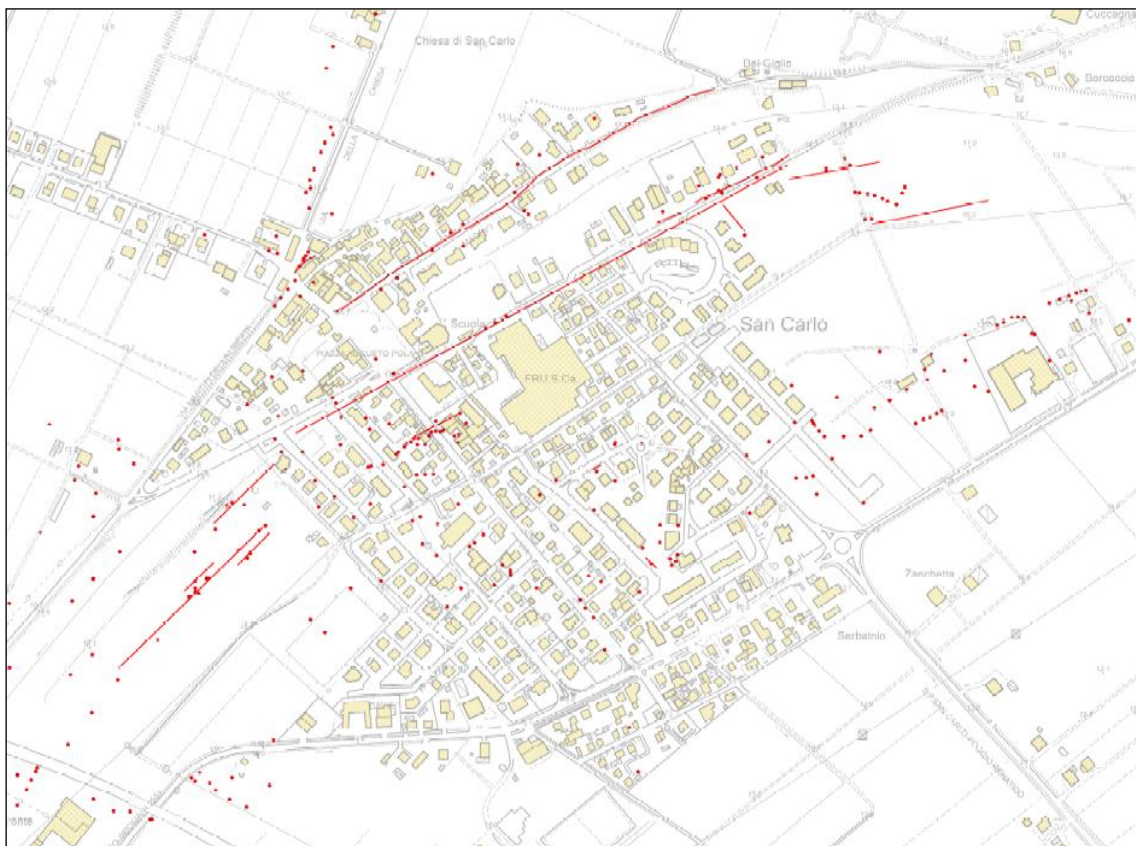
Figura A3.1 - Effetti della liquefazione osservati a S. Carlo di Sant'Agostino.
